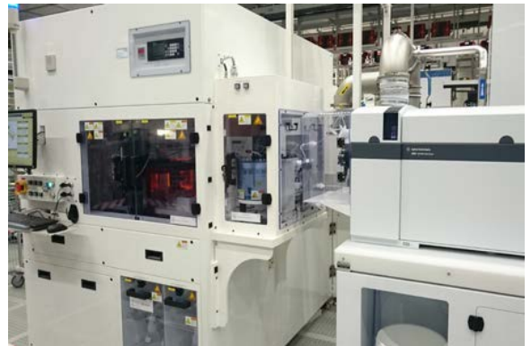
IAS Inc.가 제조한 전문 PS 전자동 VPD-ICP-MS 시스템으로, Agilent 8800 ICP-MS/MS가 통합되어 있습니다. 이 그림은 ST Microelectronics(Crolles, France)에서 제공했습니다.
